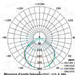
Diagramme de distribution de la surface du cône d'intensité maximale
